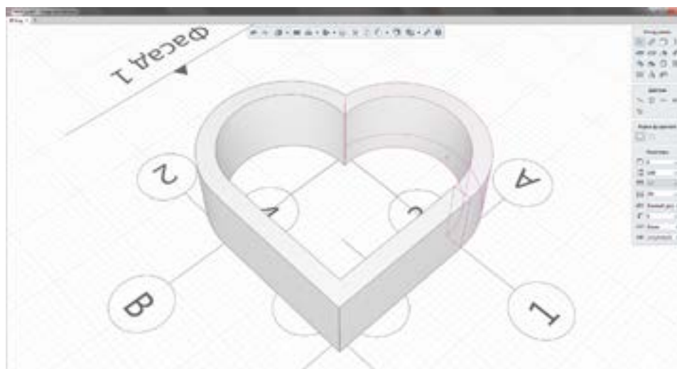
Пример фундамента, созданного на основе осей
